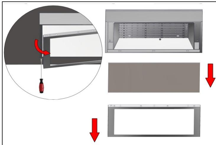
1) Ürünün çerçevesi tornavida yardımı ile gövdeden ayrıılır.
